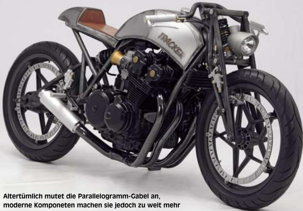
**Altertümlich mutet die Parallelogramm-Gabel an, moderne Komponenten machen sie jedoch zu weit mehr als einer Wackelvorrichtung**
