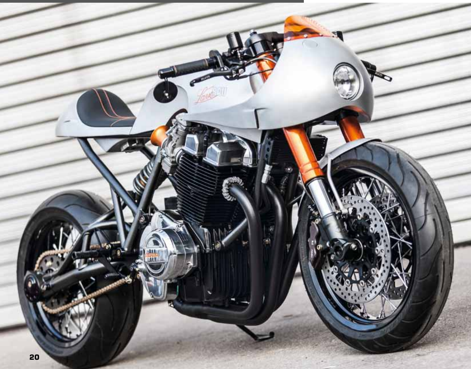
Ein klassisches Kombiinstrument von motogadget genügt als Cockpit vollauf (oben). Der Dreizylinder-dohc-Motor dominiert das schlanke Motorrad (unten)
