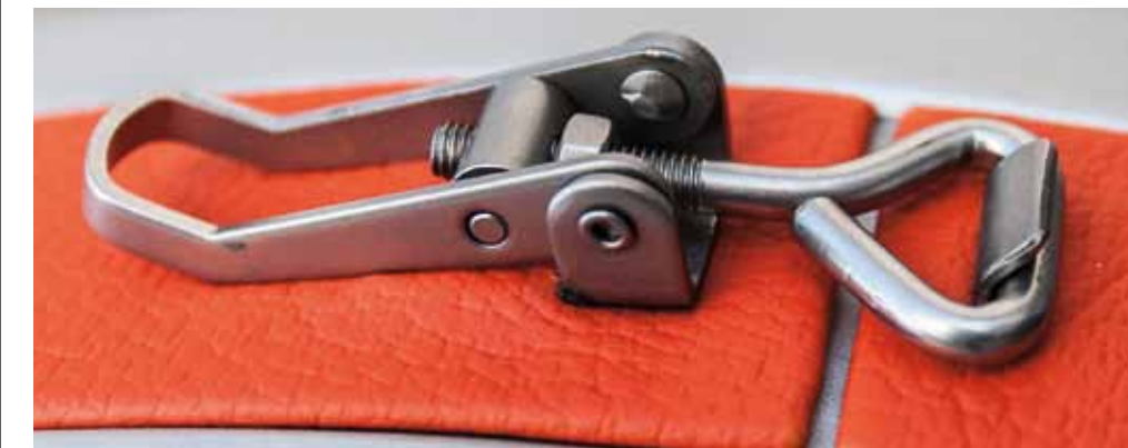
Schnellverschluss: Mit einem schnellen Handgriff kann der handgedungelte Alutank vom Rahmen genommen werden
