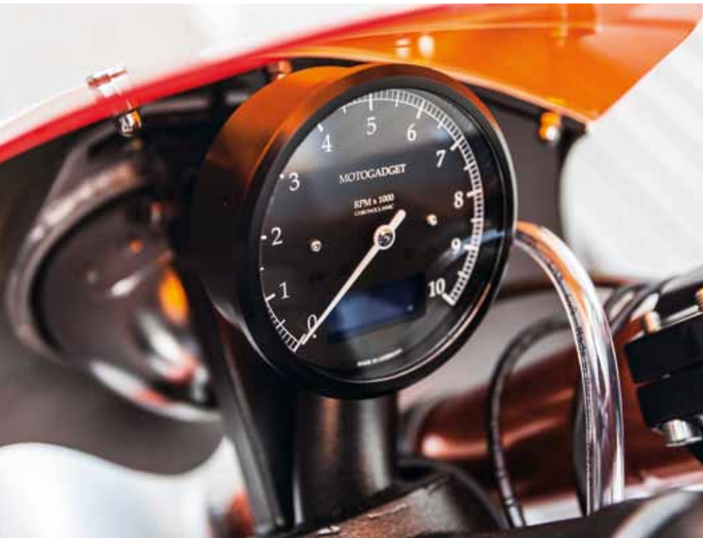
Ein klassisches Kombiinstrument von motogadget genügt als Cockpit vollauf (oben). Der Dreizylinder-dohc-Motor dominiert das schlanke Motorrad (unten)
